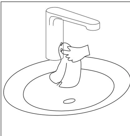
Tras la instalación, limpiar la pantalla de sensor con una toalla seca.
